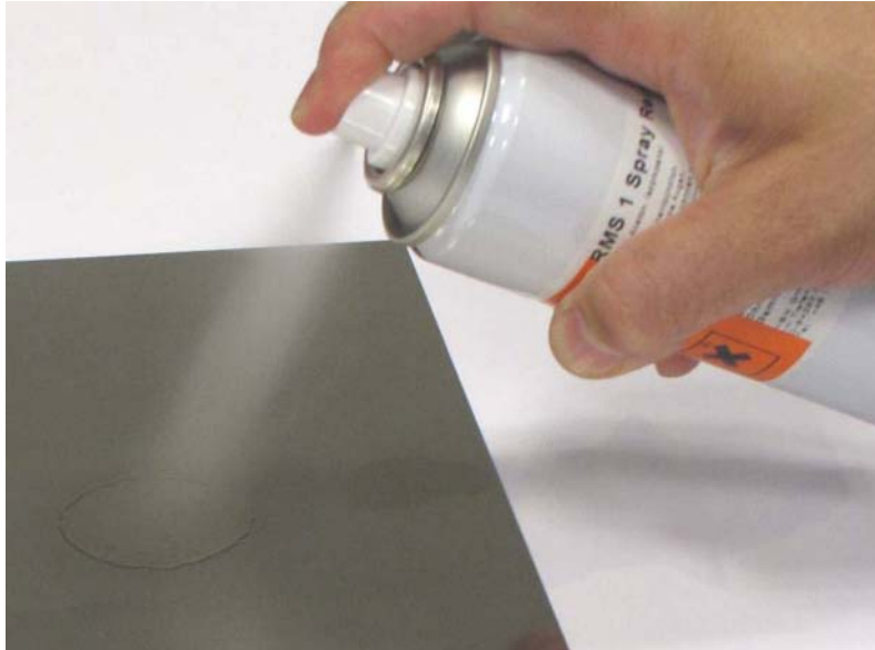
Abb. 2.1: Besprühen der Messstelle mit 1-RMS-SPRAY
