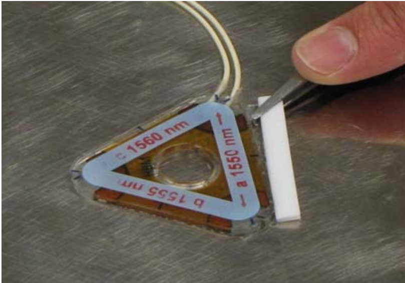
Abb. 5.10: Entfernen der Teflon-Installationshilfe
