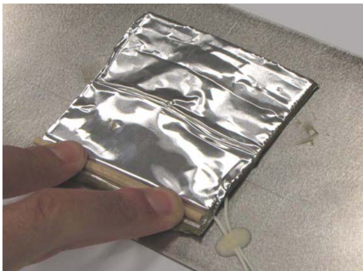
Abb. 6.2: Abdecken und Andrücken der Abdeckfolie ABM75
