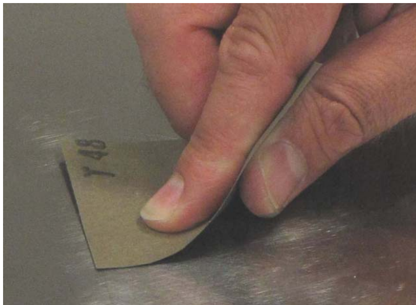
Abb. 2.3: Aufrauen der Oberfläche des Messkörpers
