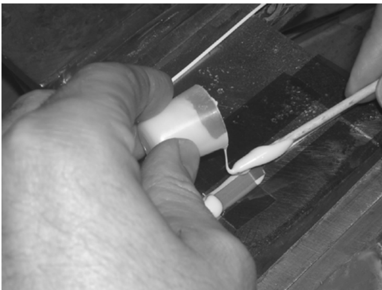
Abb. 7.18: Auftragen des Klebstoffs X60
