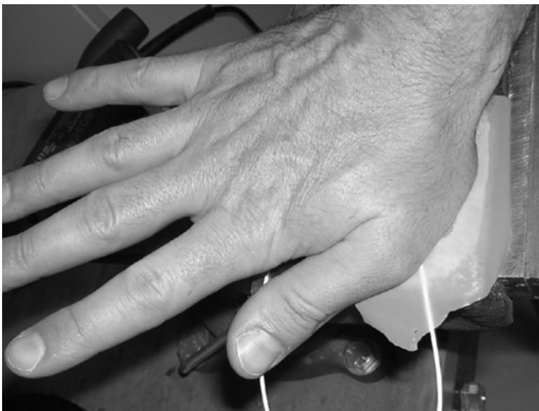
Abb. 7.12: Gleichmäßiges Andrücken des DMS
