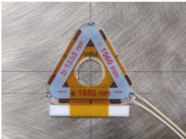
Abb. 5.1: Ausrichtung der optischen Rosette am doppelten Markierungskreuz
